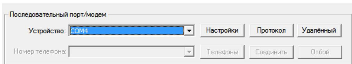
*Если ПК не имеет последовательных портов, то возможно подключение через адаптеры USB-COM. Для многих адаптеров необходимо установить дополнительное ПО и драйверы. После завершения подготовки адаптера на ПК появится виртуальный COM порт, который можно выбрать в поле «Устройство». В случае использования адаптера, необходимо запомнить, что ПО PAS нужно открывать после подключения адаптера к ПК.*
