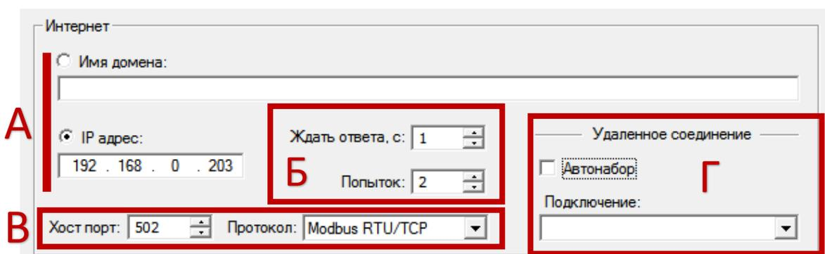
По умолчанию IP адрес прибора 192.168.0.203. Для соединения прибор и ПК с ПО PAS должны находиться в одной подсети IP адресов. Т.е. при установке соединения с прибором, у которого IP адрес 192.168.0.203, у ПК должен быть установлен статичный IP адрес в диапазоне от 192.168.0.1 до 192.168.0.255, но не 192.168.0.203, т.к. этот адрес занят прибором.
